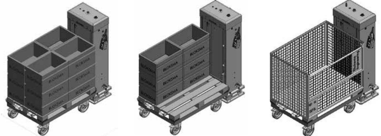
Achtung: Bei mehreren Behältern (nebeneinander und/oder hintereinander) Reichweite und Position des Sensors beachten. Unter Umständen sind zwei Sensoren notwendig. Zudem ist die Reihenfolge des Entnehmens oder der Beladung zu beachten.
